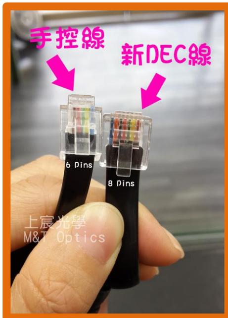
提供一則我們遇到的情形，如果您的手控器上顯示不是您赤道儀的型號，並且因為手控器抓不到正確的赤道儀而無法啟動，那麼就是有可能您曾經將 Dec Port 和手控 Port 接錯過，導致手控器錯誤，這樣真的就必須更換赤道儀套件才有辦法解決了 Q\_\_Q
