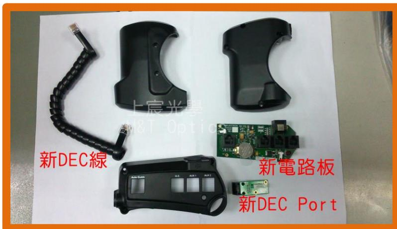
Celestron 提供了原廠赤道儀的套件升級，多了防呆的功能。升級後的赤道儀手控器的連接線接頭和 Dec 線的接頭改成一大一小，不僅如此，因為接線的改變，赤道儀上的 Dec Port 也跟著改變了，所以這款升級套件也改變了插孔的面板，如此一來，不管是哪一條線，將不再接錯囉!!真是觀星人的一大福音呢!!
